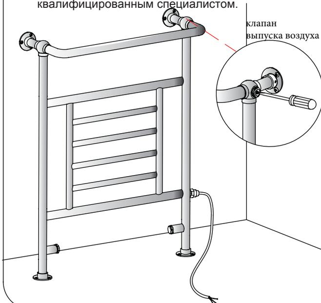
После установки, с помощью отвертки откройте клапан выпуска воздуха и дождитесь когда ТЭН закончит работать. На этом этапе возможен выход избыточной воды. Закройте клапан и полотенцесушитель готов к использованию!
