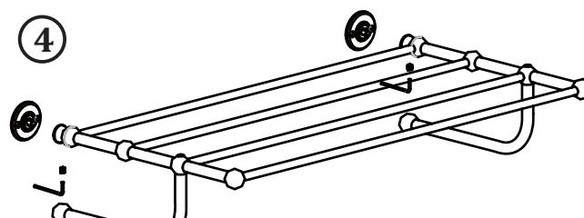
Вставьте полку в основу и зафиксируйте при помощи шестигранного ключа (в комплекте поставки).
