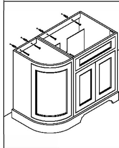
• Проверьте уровень дверцы. Для регулировки прокрутите винт в петле.
