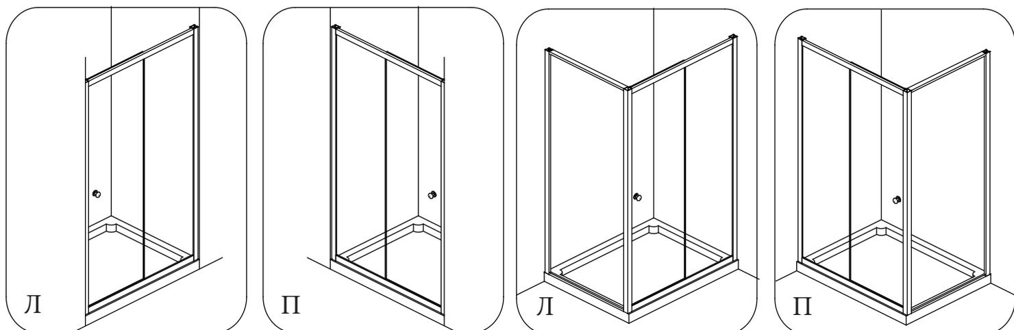
Ручка раздвижной душевой двери может устанавливаться как на левую, так и на правую сторону. Если вы устанавливаете ограждение на левую сторону, вы просто игнорируете рисунок ниже. Для установки на правую сторону, следуйте рисунку ниже.
