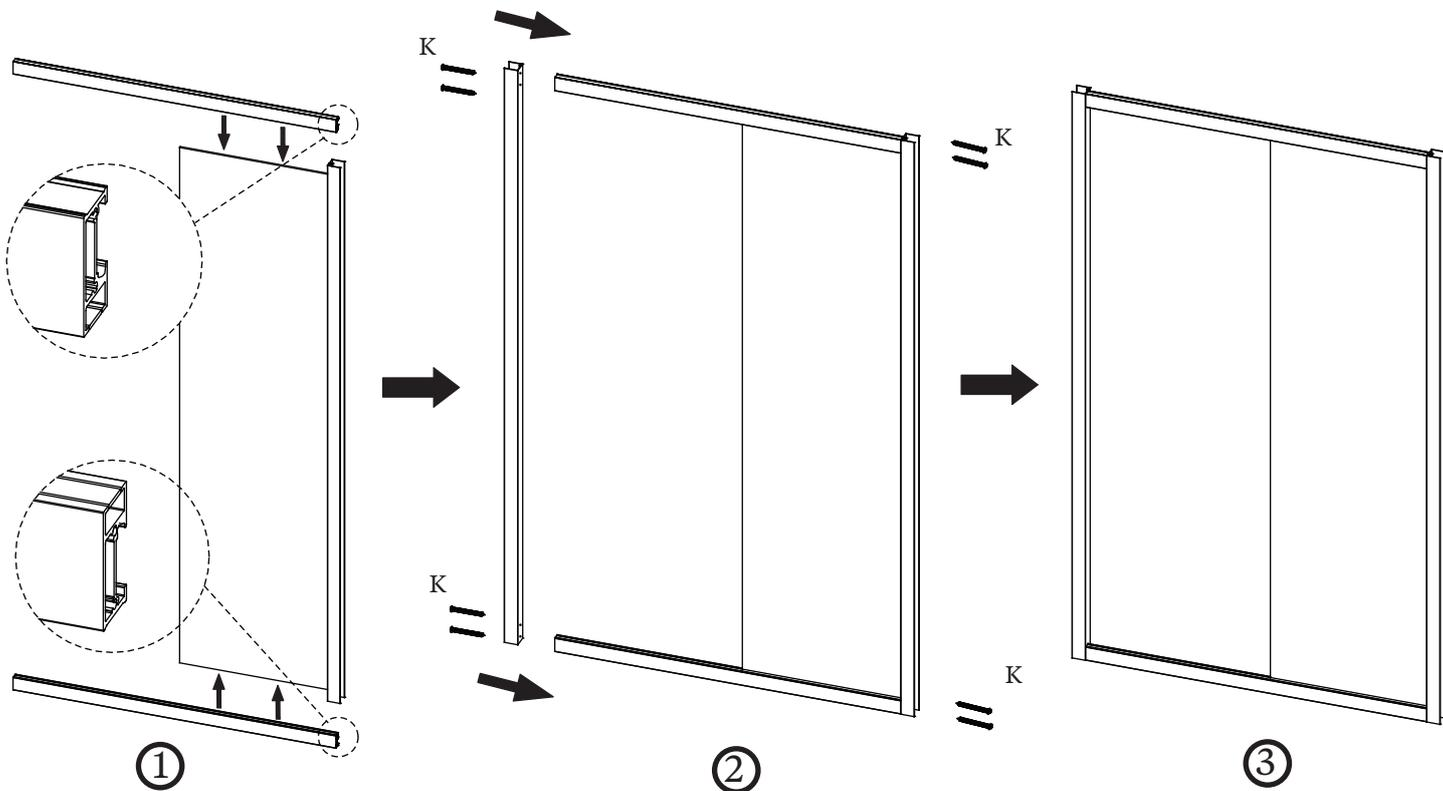
Шаг 2 - КРЕПЛЕНИЕ И РАЗМЕЩЕНИЕ СТЕНОВОГО ПРОФИЛЯ
