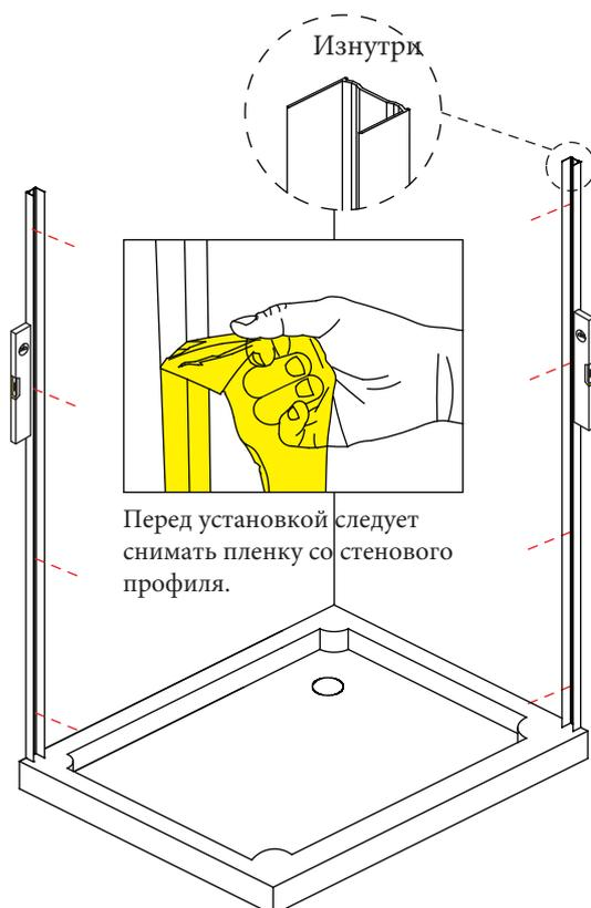
Снимите оба стеновых профиля с рамы стеклянного экрана. Примечание: При креплении убедитесь, что длинная сторона каждого стенового профиля находится внутри душевого ограждения. Поместите каждый стеновой профиль на его место на душевом поддоне (10-15мм внутрь от внешнего края поддона), с помощью уровня проверьте, чтобы они стояли вертикально, и отметьте 8 точек для крепежных отверстий на стене.
