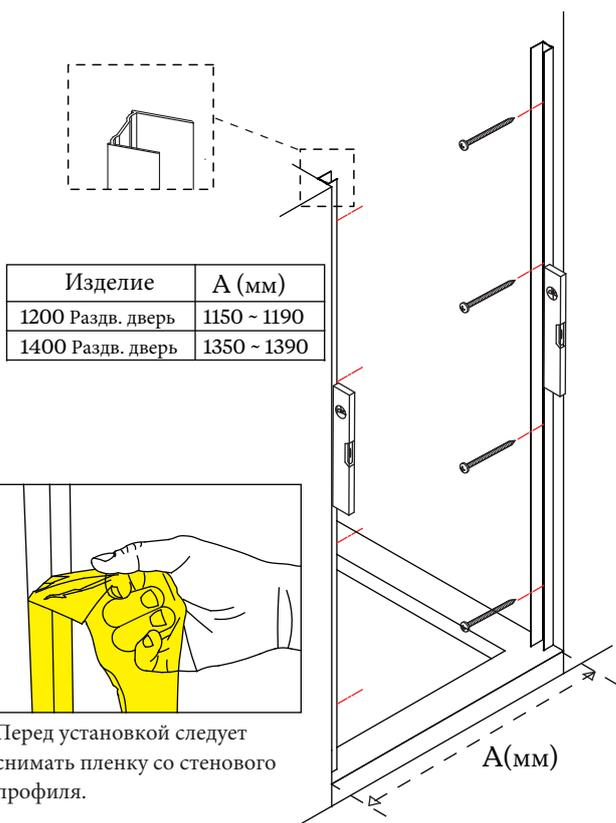
Снимите оба стеновых профиля с рамы стеклянного экрана. Примечание: При креплении убедитесь, что длинная сторона каждого стенового профиля находится внутри душевого ограждения. Поместите каждый стеновой профиль на его место на душевом поддоне (10-15мм внутрь от внешнего края поддона), с помощью уровня проверьте, чтобы они стояли вертикально, и отметьте 8 точек для крепежных отверстий на стене.
